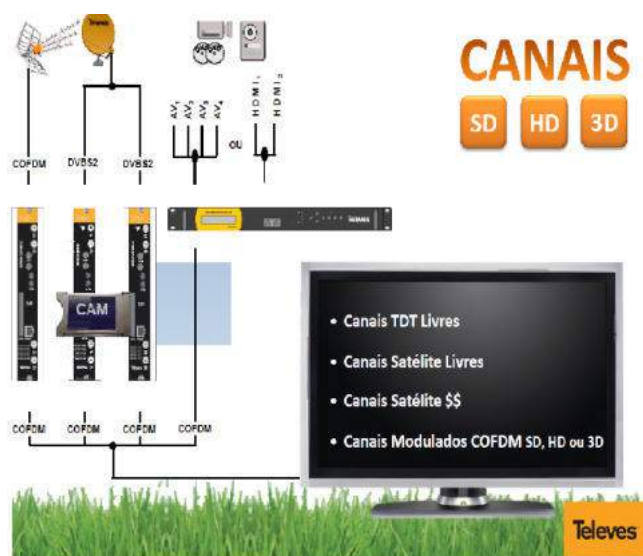
Figura 3 – de receção conjunta de TDT e SMATV (cortesia TELEVÉS)
