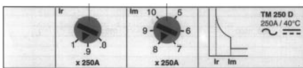
Figura 4. Painel de regulação do relé eletrónico TM250D (Fonte Schneider Electric)
