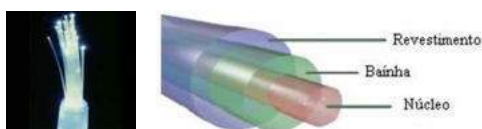
Figura 1 – Constituição típica de uma fibra ótica
