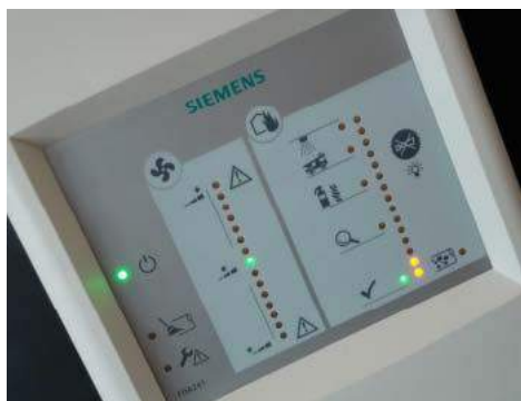
Figura 6. Sistema de deteção de incêndios por aspiração [SIEMENS]
