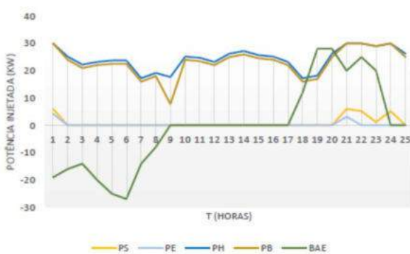
Figura 7. Níveis de produção das unidades geradoras da Smart Grid com ligação à BAE – Simulação Matlab
