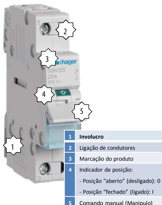
Figura 1. Principais elementos constituintes de um interruptor para instalações elétricas fixas, domésticas ou análogas de alavanca, de montagem em painel
