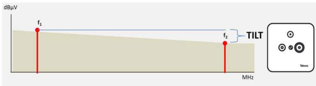
Figura 1. TILT – Diferença de sinais a frequências diferentes num mesmo ponto da rede de cabo coaxial
