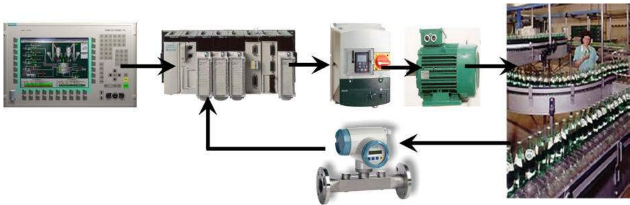
Figura 2 – Arquitetura genérica de um sistema industrial automatizado
