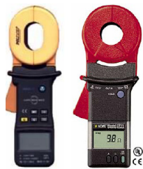
Figura 9. Medição da resistência de terra com recurso a pinças de medição de terra
