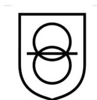
Transformadores de separação em que a tensão do secundário em vazio é inferior a 50 V.
