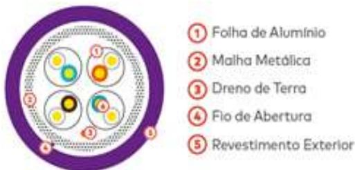
Figura 4 - Imagem técnica Cabo Cat.6A S/FTP LSZH CU 4P AWG23 barpa
