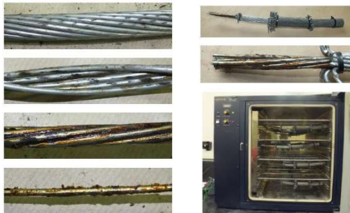
Figura 4. Análise do estado das diferentes camadas dos condutor e teste de temperatura da massa
