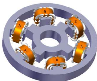
b) MRC trifásico: 6 polos no estator e 4 no rotor (6/4)
