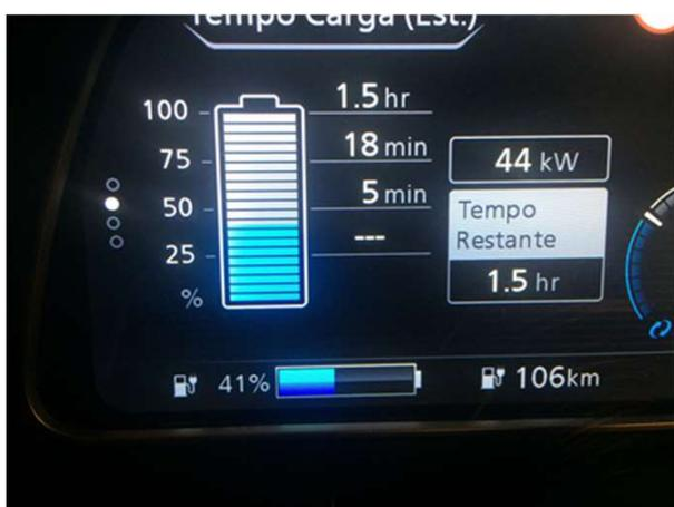
Figura 2.9 – Carregamento rápido de 50 kW DC
