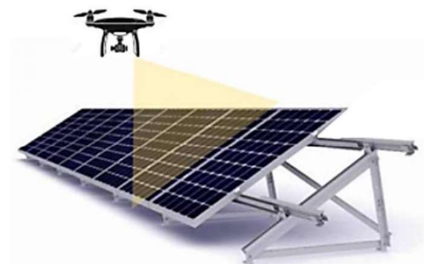
Figura 2 - Ilustração do Procedimento de uma Inspeção Termográfica com Drone
