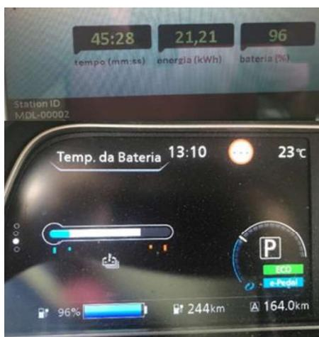
Figura 1.4 – Leaf II (carga no PCR de Mirandela)
