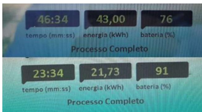
Figura 5.4 – KEV6GTL (dados de duas cargas em PCR)
