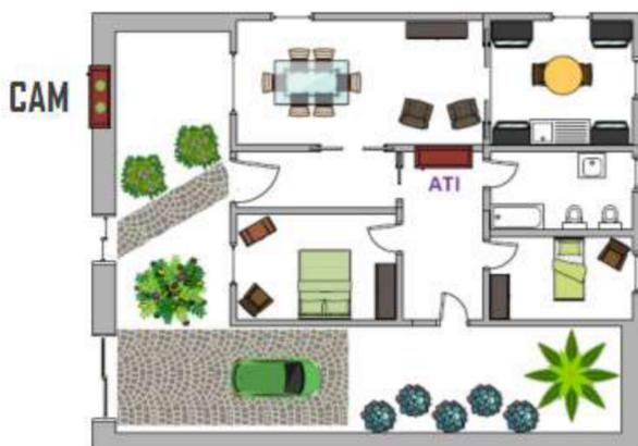
A CAM é constituída por uma caixa com dimensões mínimas de L220xA220xP90mm e por 2 tubos com dimensões mínimas de Ø63mm que prolongam a sua face inferior até ao subsolo.
