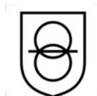
Transformadores de separação em que a tensão do secundário em vazio é inferior a 50 V.
