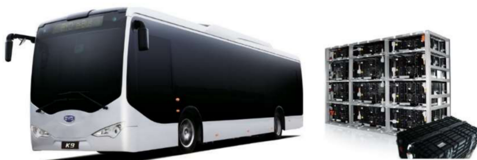
Figura 3- À esquerda: Autocarro BYD 100% elétrico; À direita: Respetivo Pack de baterias LFP
