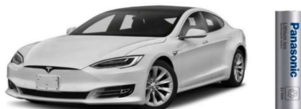
Figura 4 - À esquerda: Tesla Model S; À direita: Respetiva Células Panasonic 18650 NCA
