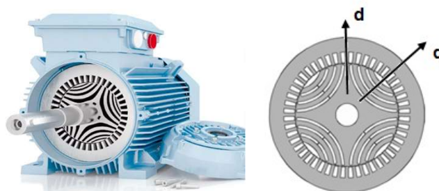
Figura 4– Motor Síncrono de Relutância trifásico (4 polos)
