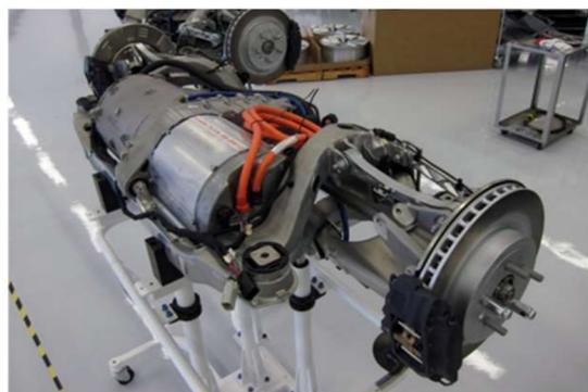
Figura 2.2. Motor AC de indução do Tesla S[7]
