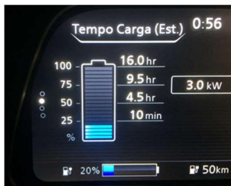
Figura 2.7. Tempo de carga numa tomada monofásica de 16A
