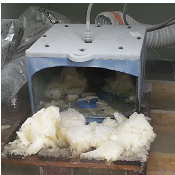
Figura 2 - Teste realizado em caixa de terminais em temperatura negativa
