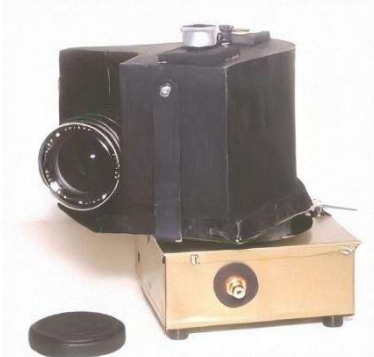
Figura 2: Câmera fotográfica que registra imagens em 360° inventada por Sebastião Carvalho Leme
