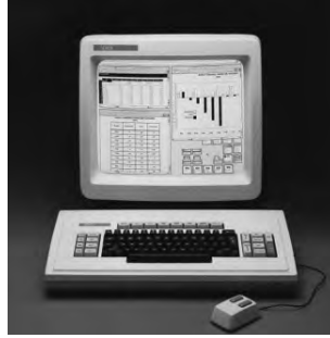
Fig. 4 Xerox Star. O primeiro computador comercial com interface gráfica.
